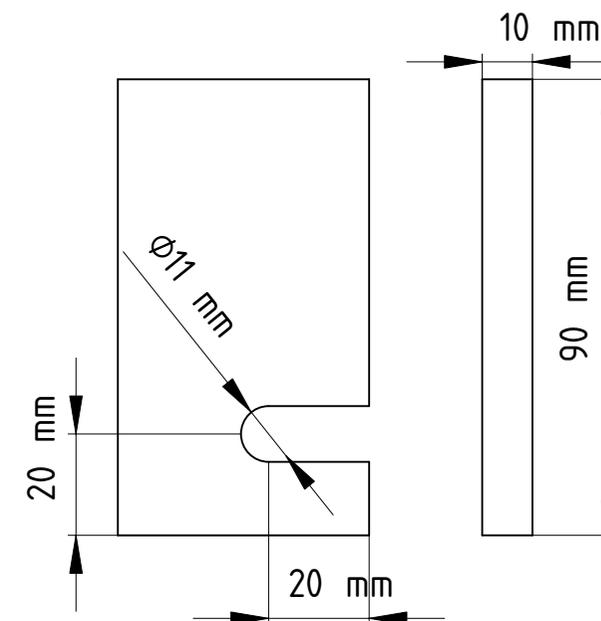
A7 - Platine de boulonnage des roues
