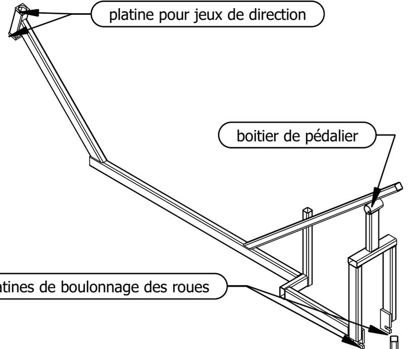
platinas de boulonnage des roues
