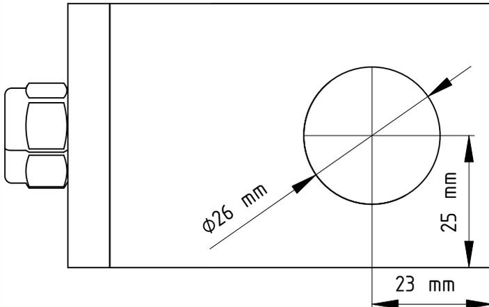
Pour souder les 2 pièces M1 à la pièce M2 utiliser un tube de 50X30 mm plus une fine calle de métal ou de carton
