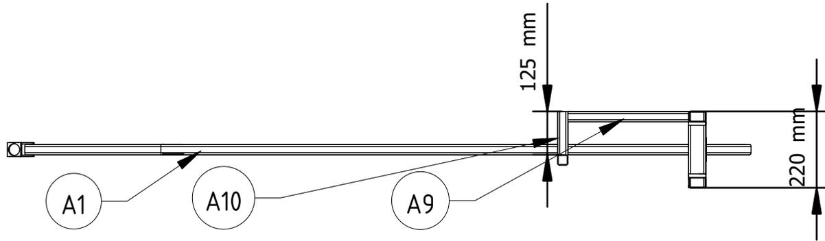
L'ensemble A1 - A10 et A9 est plan. Il peut alors être monté puis utilisé comme gabari pour produire de la chaîne (Technique enseignée en formation)
